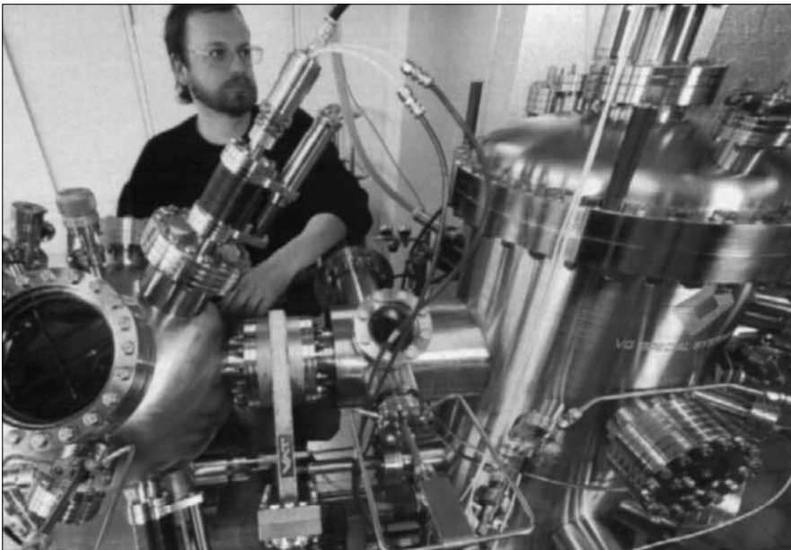
Beschichtungsanlage in Saarbrücken: Bleibarriere für die Karaffe
