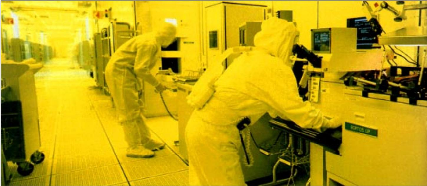
**Chip-Herstellung im Intel-Reinraum:** Nur Roboterhände dürfen die spiegelnden Siliziumscheiben berühren
