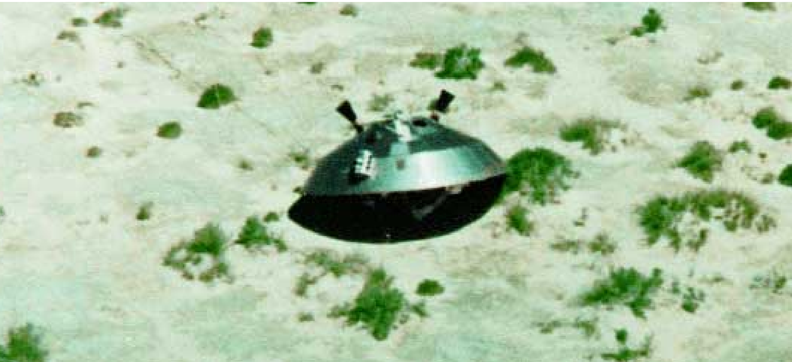
Prototyp der Marslandesonde „Viking“ nach dem Aufsetzen in der Wüste von New Mexico*: Zischeind zur Erde
