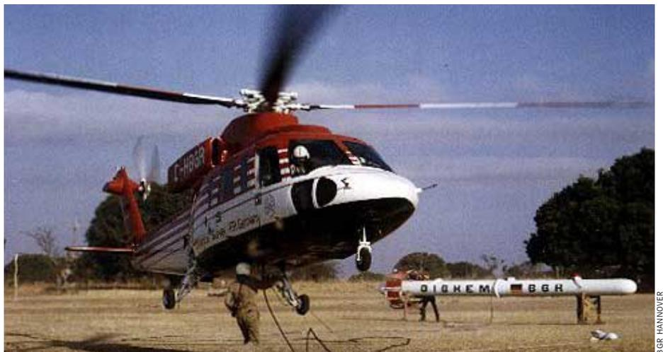
**BGR-Forschungshubschrauber, Suchsystem: Magnetsensoren spähen in die Tiefe**
