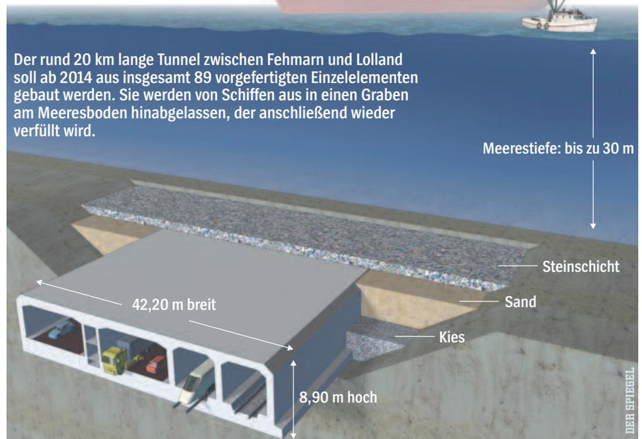
Der rund 20 km lange Tunnel zwischen Fehmarn und Lolland soll ab 2014 aus insgesamt 89 vorgefertigten Einzelelementen gebaut werden. Sie werden von Schiffen aus in einen Graben am Meeresboden hinabgelassen, der anschließend wieder verfüllt wird.
