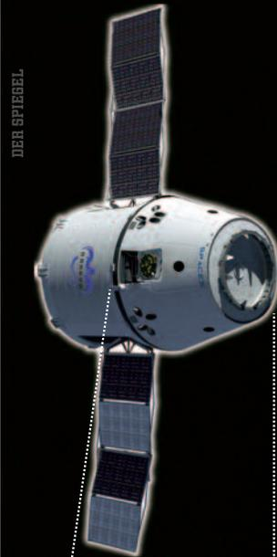
Kopplungsadapter für die ISS
