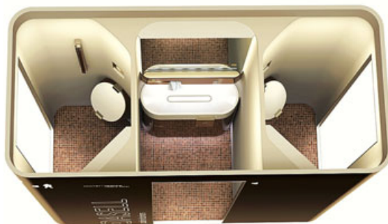
Urinal-Modul für den Airbus A380
