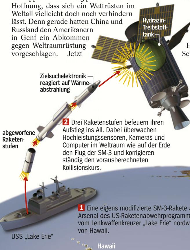
**2** Drei Raketenstufen befeuern ihren Aufstieg ins All. Dabei überwachen Hochleistungssensoren, Kameras und Computer im Weltraum wie auf der Erde den Flug der SM-3 und korrigieren ständig den vorausberechneten Kollisionskurs.
