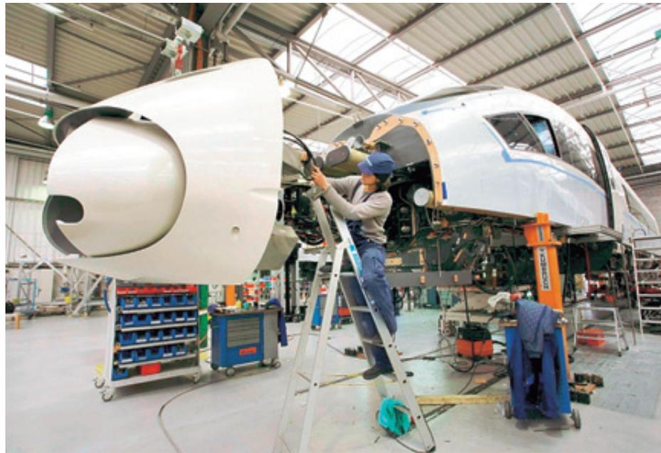
**Bau von Siemens-Schnellzügen (in Krefeld):** Abtrennen, aufpäppeln und verwerten?
