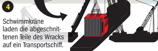
Schwimmkräne laden die abgeschnittenen Teile des Wracks auf ein Transportschiff.
