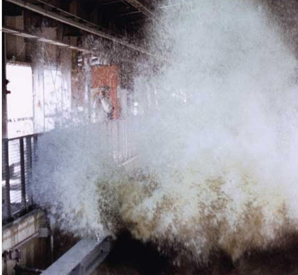
Erzeugung einer Riesenwelle im Testtank der Uni Hannover: „Uns flogen die Trümmer vom
