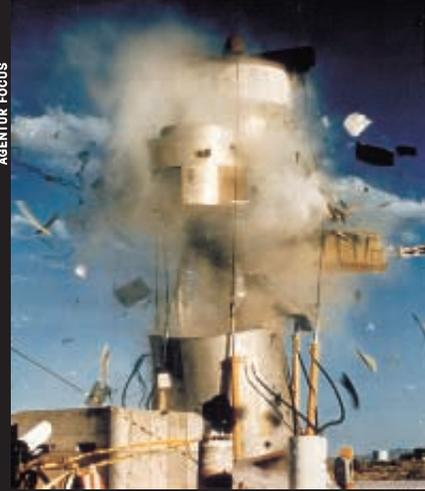
Test einer Laserkanone an der zweiten Stufe einer Titan-1-Rakete
