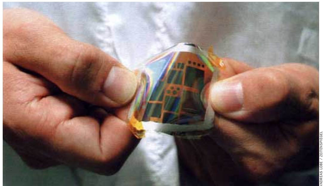
Solarzelle auf Plastikfolie: Bis zu 50-mal dünner als ein Haar
