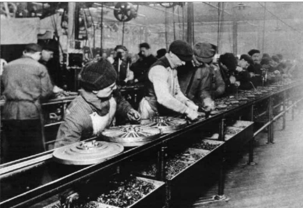
**Fließbandfertigung bei Ford (1913):** Möglichst schnell die immer gleichen Handgriffe
