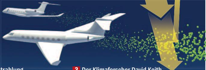
**3** Der Klimaforscher David Keith schlägt hingegen ein Geoengineering-Programm vor, das die Sonneneinstrahlung reduzieren soll: Flugzeuge könnten in der Stratosphäre ein schwefelhaltiges Aerosol freisetzen, das einen Teil der Strahlung reflektiert. Es käme ein Kühleffekt zustande wie nach Vulkanausbrüchen.
