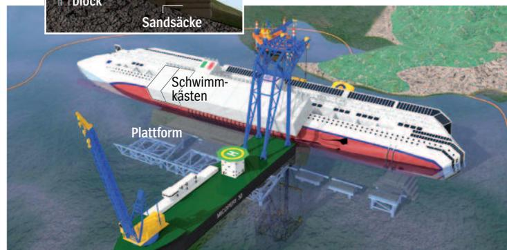
**Ende 2012 / Anfang 2013:** Unter Wasser wird eine Plattform errichtet, die das Schiff später auffangen soll. An der Backbordwand befestigen Schweißer 15 Schwimmkästen mit bis zu 33 Meter Höhe.
