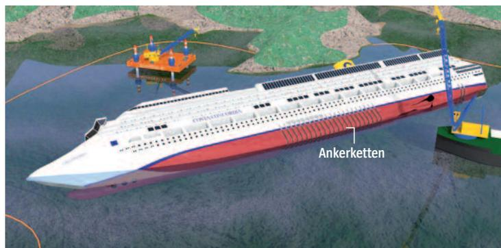
**Aktueller Stand des Projekts:** Ankerketten, die an der Backbordwand befestigt und unter dem Rumpf hindurch gespannt werden, sichern das Wrack gegen weiteres Abrutschen.
