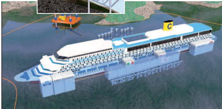
**Mai 2013:** Auch an der Steuerbordseite werden Schwimmkästen montiert. Das Wasser wird aus den Kästen gepumpt. Das Schiff bekommt Auftrieb und kann abgeschleppt werden.
