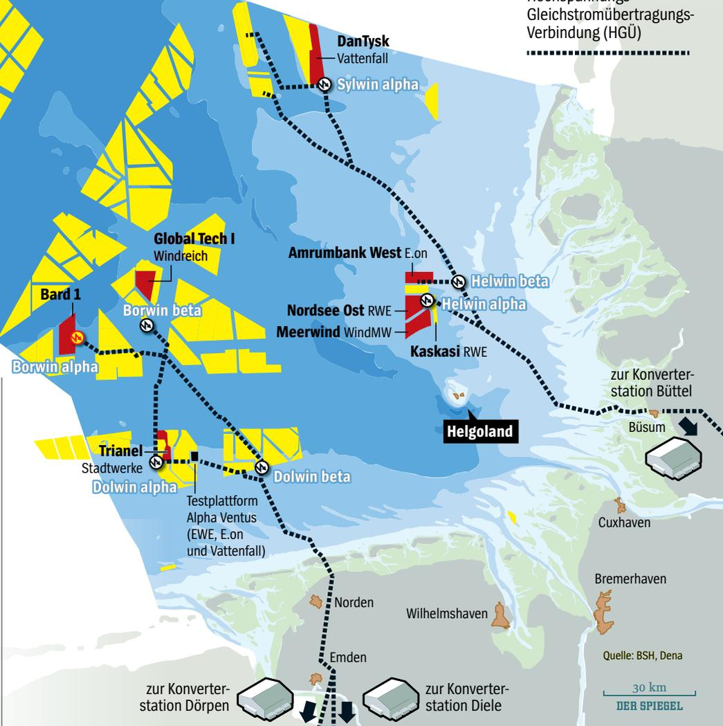
Baustart für „Bard 1“, einen gigantischen Propellergarten mit 80 Turbinen von je fünf Megawatt Leistung.
