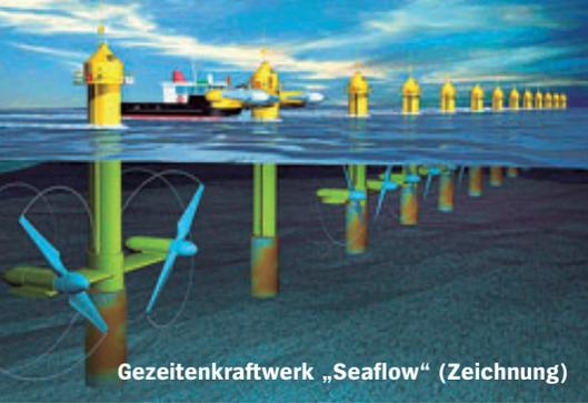
Gezeitenkraftwerk „Seaflow“ (Zeichnung)
