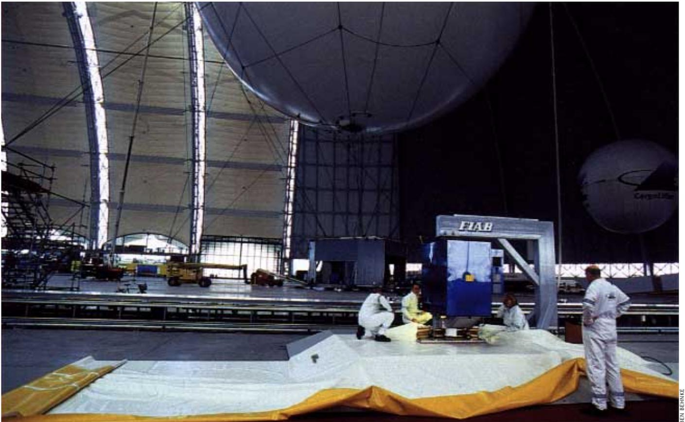
Hüllenschweißmaschine für den „Cargolifter“, Montagehalle: Geheimnis in der Kunststoffhaut
