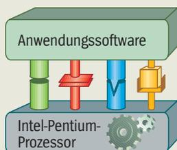
**Crusoe-Prozessoren** sind mit einer so genannten Code Morphing Software ausgestattet. Diese Software-Ebene spiegelt den Anwendungsprogrammen einen beliebigen Mikroprozessor mit dessen speziellen Befehlen vor. Wechseln die Chip-Generationen, kann die Morphing Software den neuen Prozessor optimal ansteuern, trotz neuer Chip-Befehle laufen auch die alten Programme. So kann der Chip zum Beispiel auf möglichst niedrigen Stromverbrauch optimiert werden.
