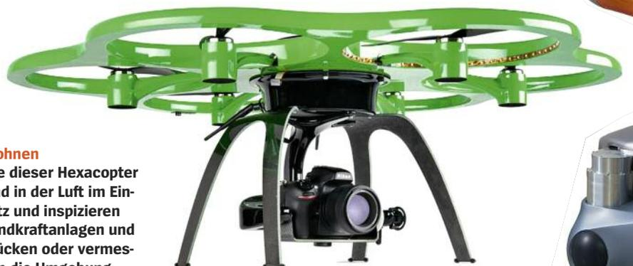
**Drohnen** wie dieser Hexacopter sind in der Luft im Einsatz und inspizieren Windkraftanlagen und Brücken oder vermessen die Umgebung.
