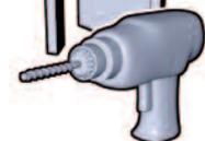
**Durchbrechen** einer Leichtbauwand mit einem Akkubohrer
